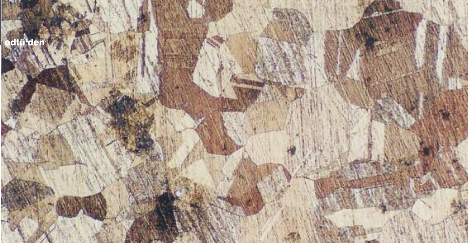
ODTÜ Müzesi'nde bulunan Frig dönemine ait bir omphalos ve onun ince kesit görüntüsü (env no:94.03.077) , büyütmeye:x100 (Ercanlı,1995)
